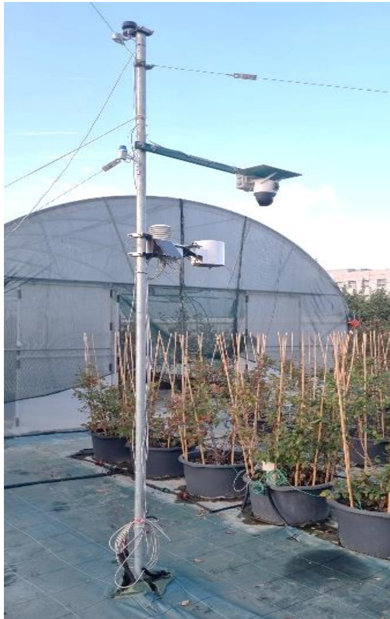
Stația meteo iMetos IMT300USW amplasată în câmpul experimental
