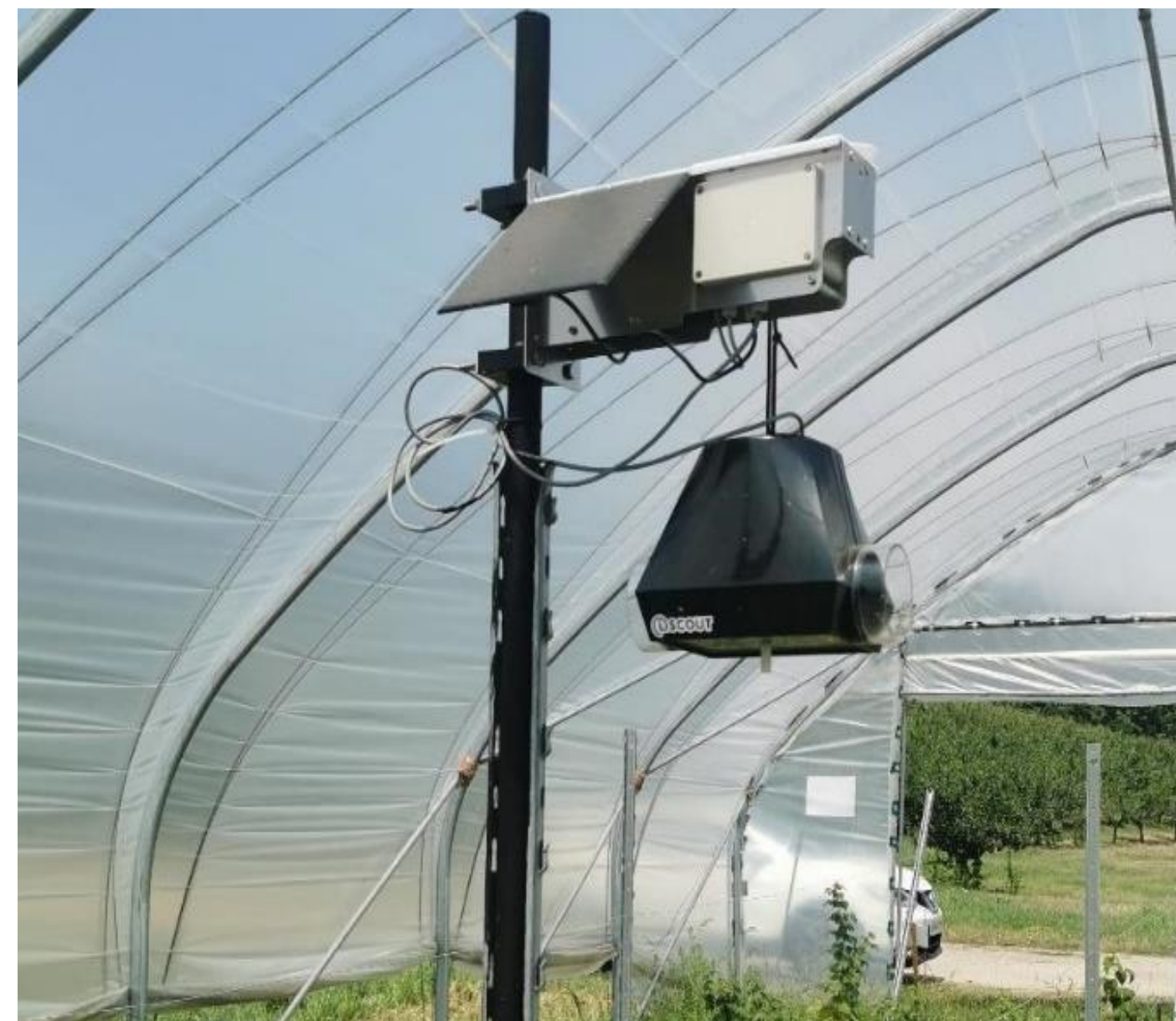
Capcana electronică iMETOS iSCOUT® utilizând momelile feromonele "atraPYR" sfredelitorul ramurilor - Zeuzera pyrina
