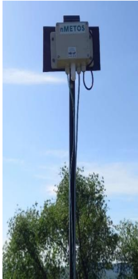
Instalarea Stației meteo mini METOS 80 SM în parcela experimentală de aronia
