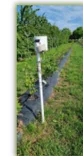
Modul experimental de afin la container (contorizare consumuri de apă, senzori de umiditate Watermark, dendrometru)
