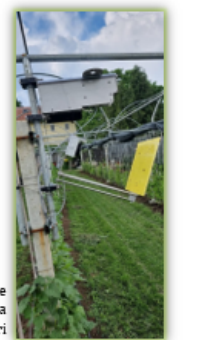
Statie meteo cu interfață multiplă de senzori, colectare date și gestionare inteligentă a informațiilor
